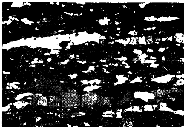
Fig. 2. — Blastomylonite du domaine septentrional. Microphotographie, lumière polarisée. Noter en particulier l'aspect caractéristique des quartz en rubans (éch. Q5C2, région du Diable, Nord de Saint-Christophe ; feuille St-Christophe n° 1 au 1/20 000 ; x = 901,57 ; y = 306,98 ; z = 2\,420 m).
